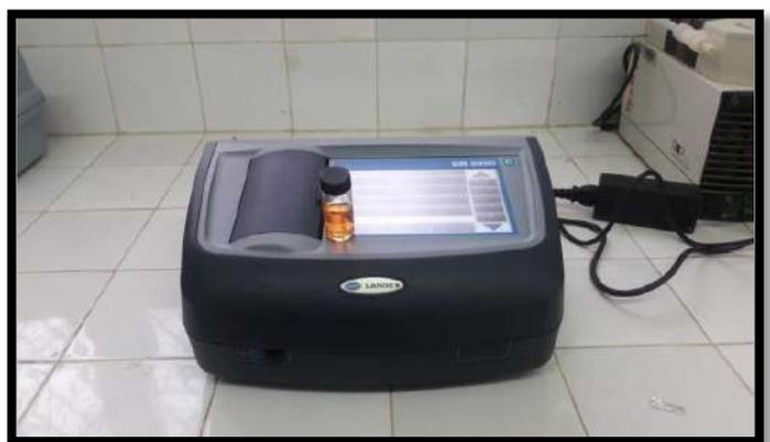
**Figure 4.6 : Spectrophotomètre DR 3900 avec cellule de fer**
