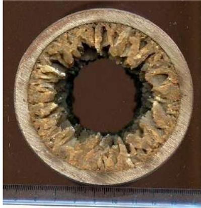
**Figure 3.2 : Dépôts de  $\text{CaSO}_4$  dans une pipe de pétrole [22].**
