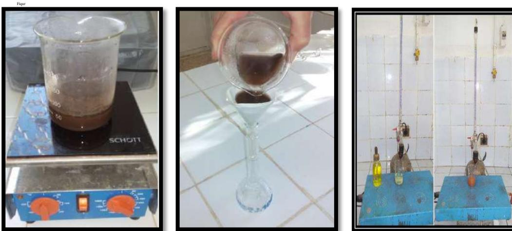
Figure 4.2 : une fiole conique avec filtre et une burette
