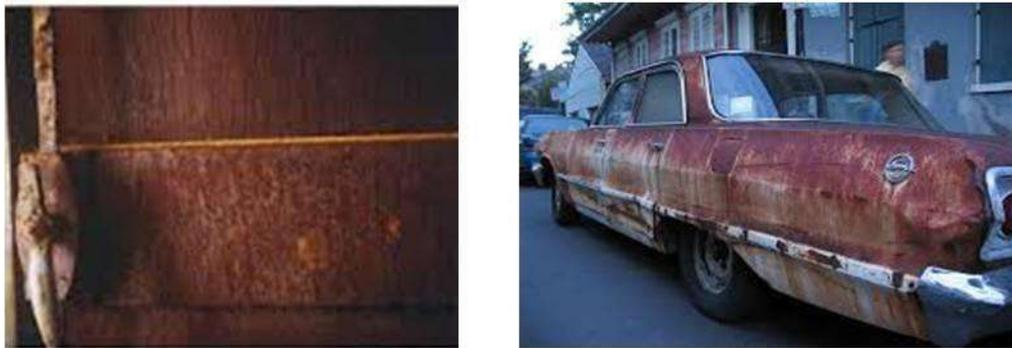
**Figure 2.1 : Corrosion généralisée : exemple d'une porte et d'un véhicule corrodés.**
