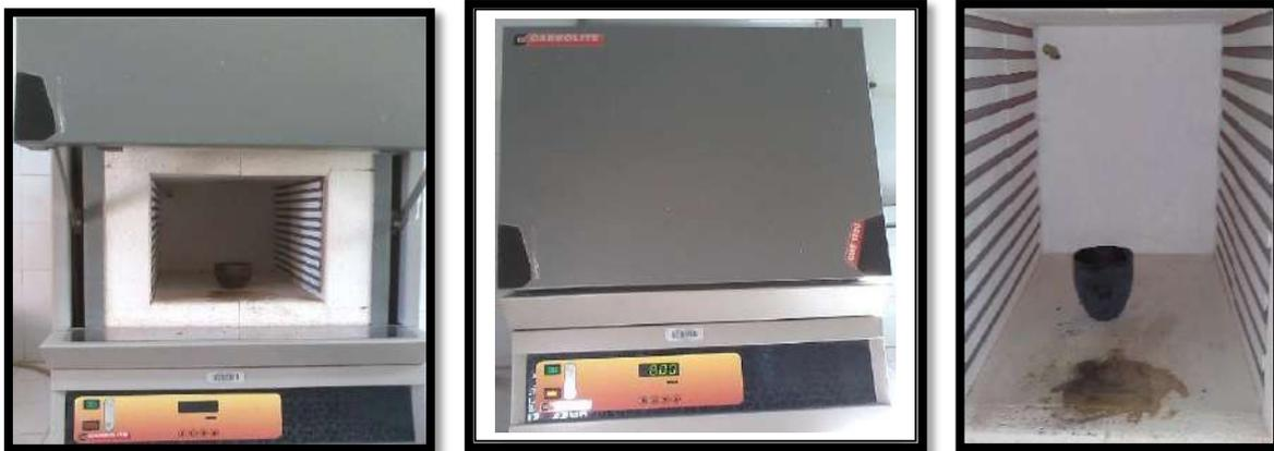
Figure 4.1 : Four à moufle avec creuset en platine
