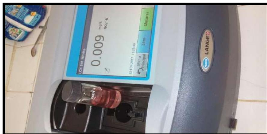
Figure 4.8 : Spectrophotomètre DR 3900 avec cellule de nitrite.
