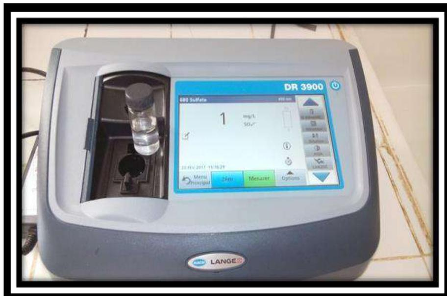
Figure 4.7 : Spectrophotomètre DR 3900 avec cellule de sulfate.
