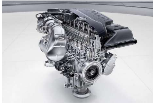
Fig. I.2 :moteur avec cylindres en ligne.[1]
