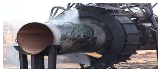
Figure(III.8): revêtement d'un tube de type thermodurcissable (STT)
