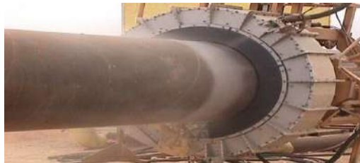
Figure (III.7): Machine de sablage automatique (STT).
