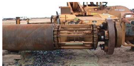
Figure(III.6): coupe et chanfrein des pipes(STT)
