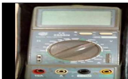
Figure (III.10): Voltmètre utilisé pour mesurer le potentiel de PC.
