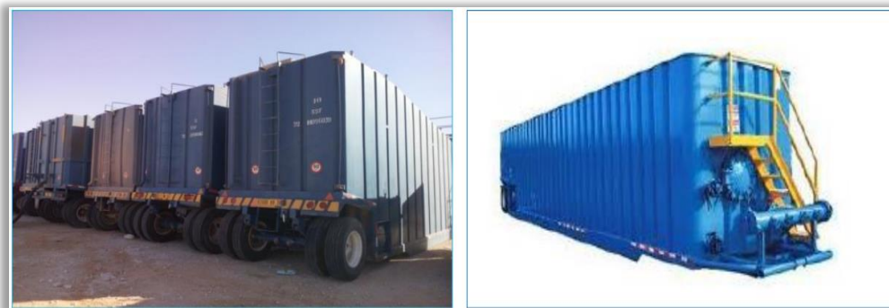
Figure 5 : Frac tank (réservoir d'eau).
