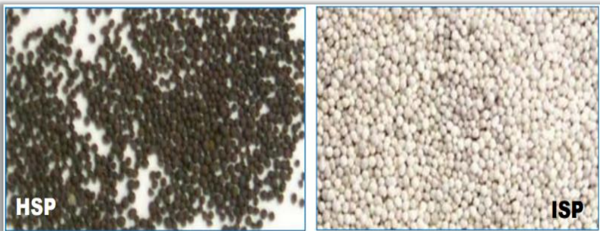
Figure IV.19 : Agents de soutènement en céramique (ISP, HSP)
