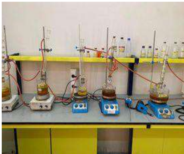
Figure III-5: Le montage de chauffage.
