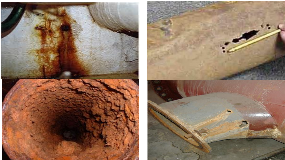
Figure IV.6 : La corrosion bactérienne à travers au champ Ourhoud.[14]
