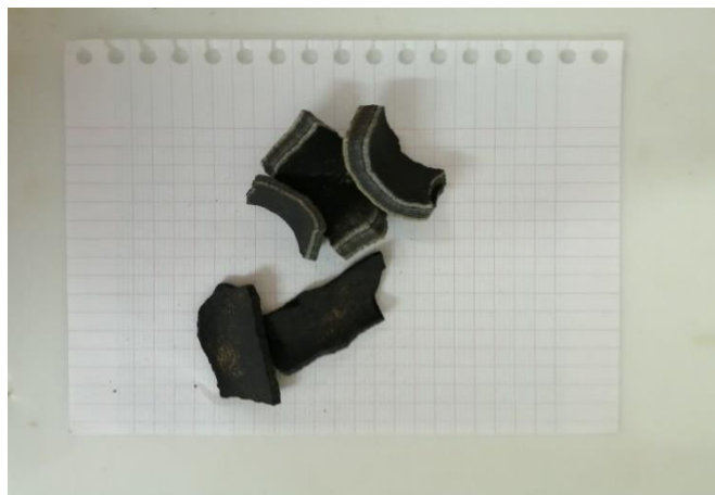
Figure IV.1 : dépôt récupéré du puits MD 480.
