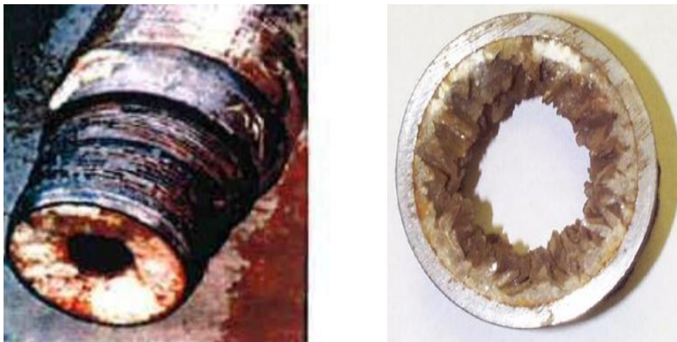
Figure I.9 : Formation des dépôts à l'intérieur des conduites. [13]
