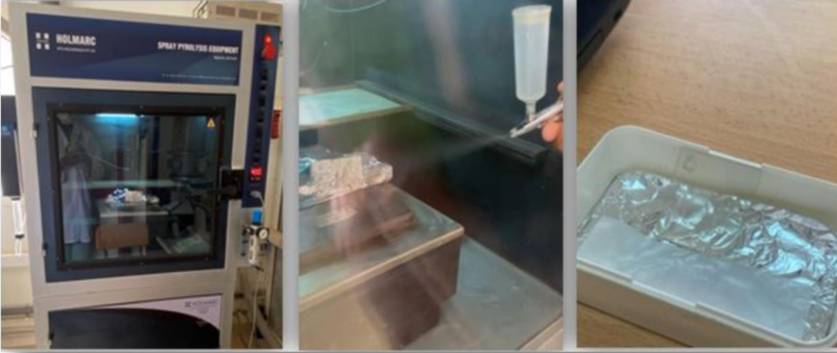
الشكل (3.III): مراحل ترسيب الأغشية الرقيقة ل Zns
