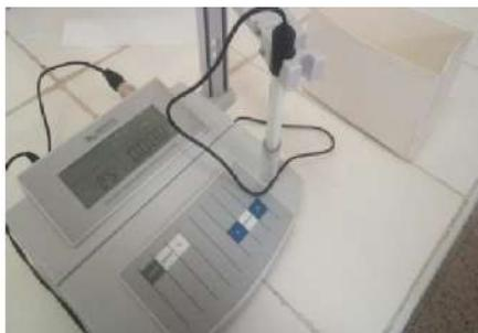
الصورة (2): جهاز قياس الناقلية
