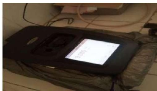
الصورة (8) : جهاز Spectrophotomètre
