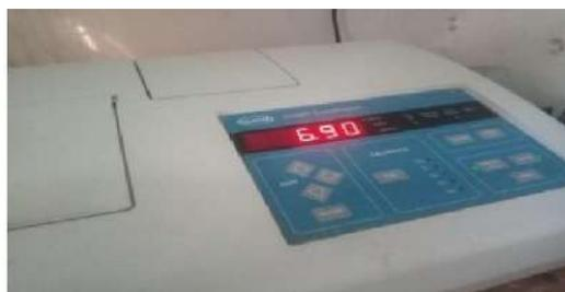
الصورة (5): جهاز قياس العكارة
