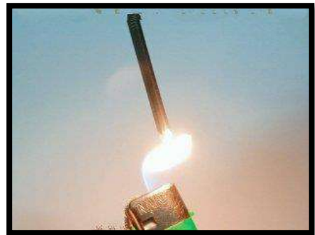
الشكل III.3: تسخين المسمار لثقب الزجاجة
