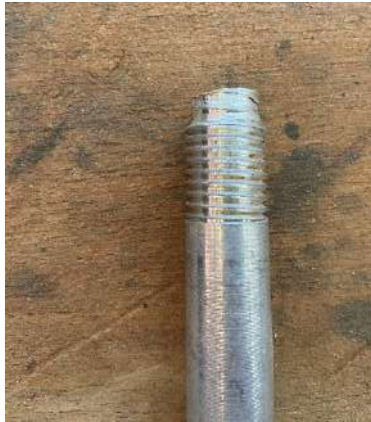
Figure III -12 vise d'assemblage endommag 
