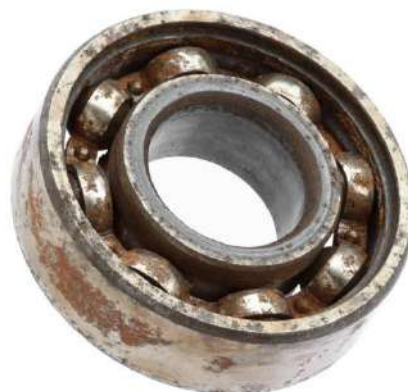
Figure III-5 un roulement endommagé
