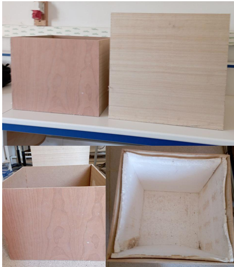
Figure III.4 : Les deux caisses en bois ont du polystyrène entre elles
