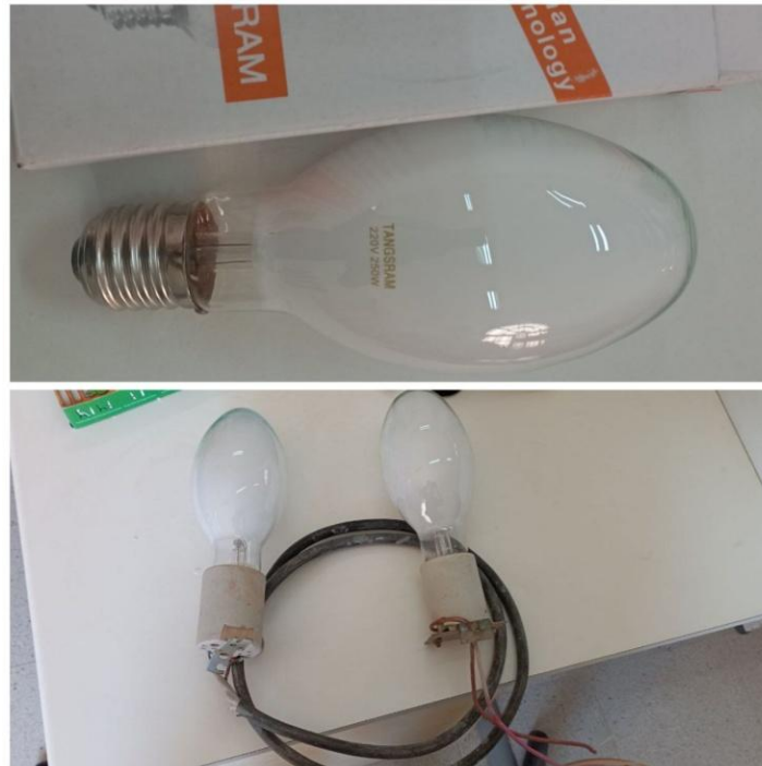
Figure III.5 : La lampe utilisée dans l'expérience comme moyen thermique.
