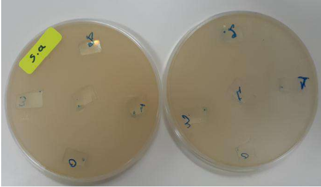
الشكل (17.II): صورة لتوزيع طبقات \text{SnO}_2 النقية والمطعمة على سطح وسط الزرع الذي يحتوي على البكتيريا من النوع Stph . aureus .
