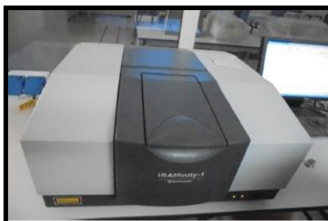
Figure II. 19. Photo de spectromètre infrarouge de type Shimadzu modèle IR Affinity-1 utilisé.
