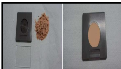
Figure II. 8. Préparation d'un échantillon pour la DRX.
