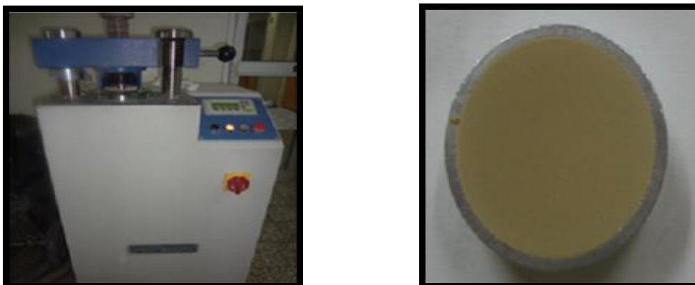
Figure II. 24. Figure montre l'appareil de compression des échantillons et la méthode de compression [43].
