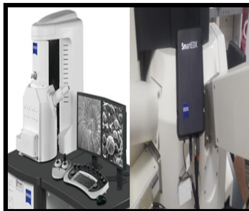
Figure II. 27. Appareil MEB équipé d'un détecteur EDS utilisé pour l'analyse.
