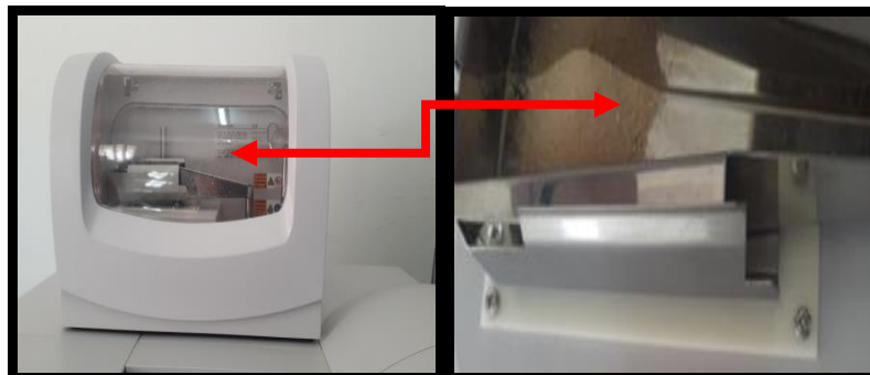
Figure II. 31. Figure montre comment placer l'échantillon pour l'analyse.
