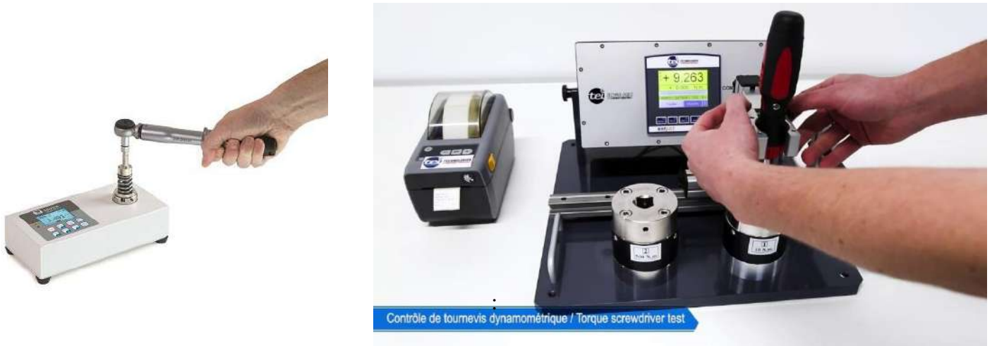
Figure N° 3.5 :Capteur et banc d'étalonnage de clé dynamométrique
