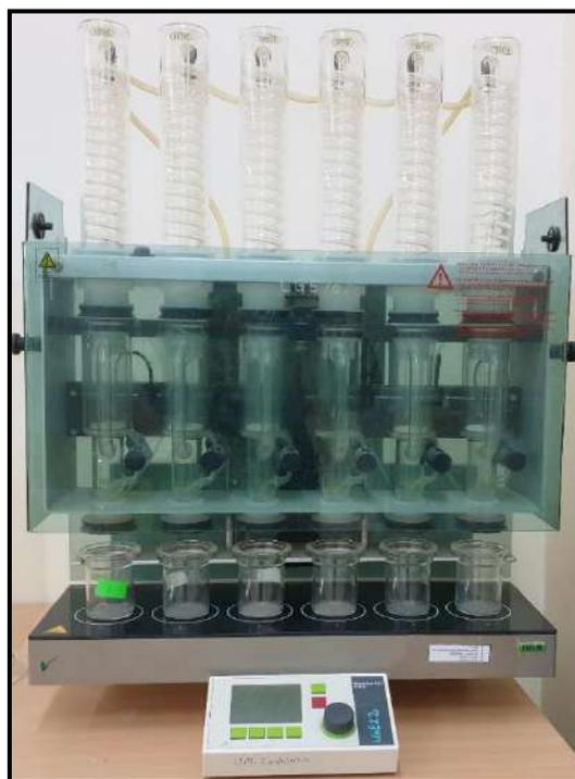
*Figure II.4 : Extracteur Soxhlet.*
