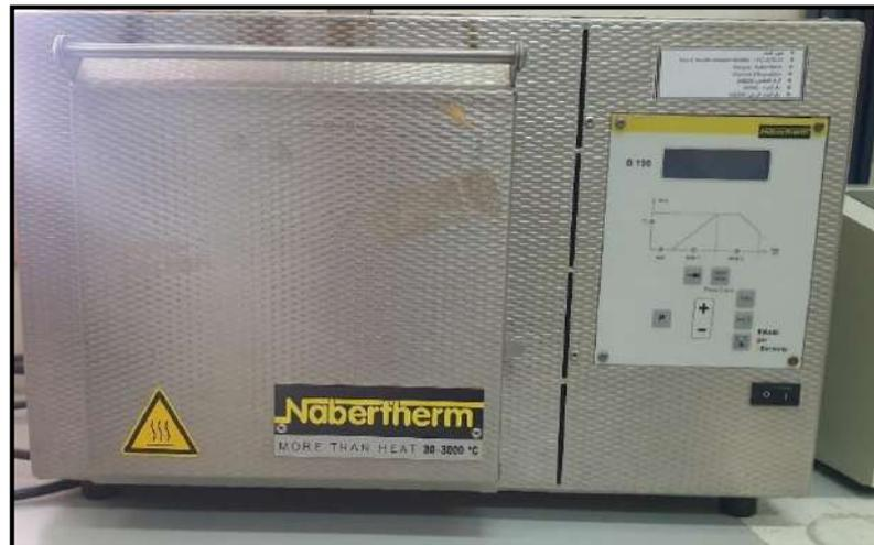
*Figure A. 3 : Four à moufle compact Nabertherm LE6/11/B150.*
