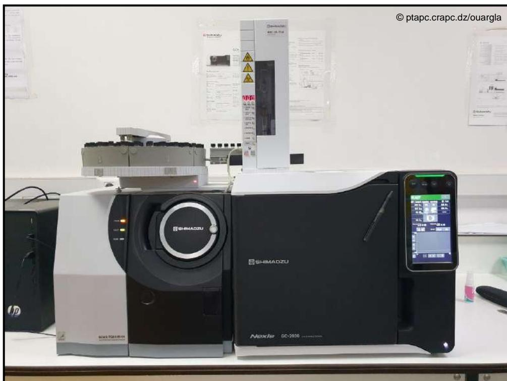
*Figure A. 5 : L'appareil de chromatographie en phase gazeuse couplée à la spectroscopie de masse SHIMADZU GCMS-TQ8040 NX.*
