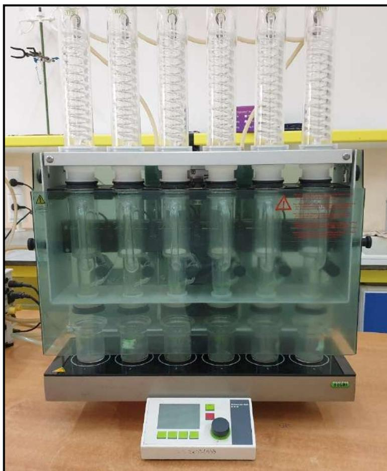
*Figure A. 1 : Unité d'extraction E-816 Soxhlet 6 places.*
