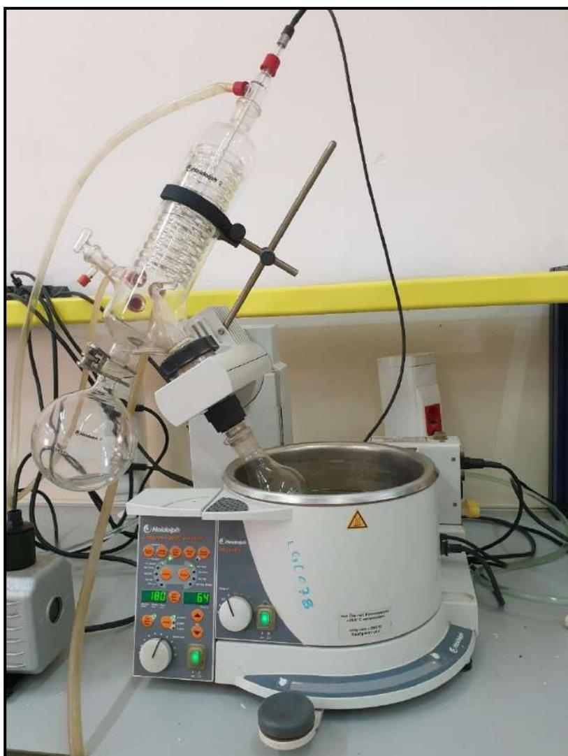
*Figure A. 2 : Evaporateur rotatif Heidolph Laborota 4002.*
