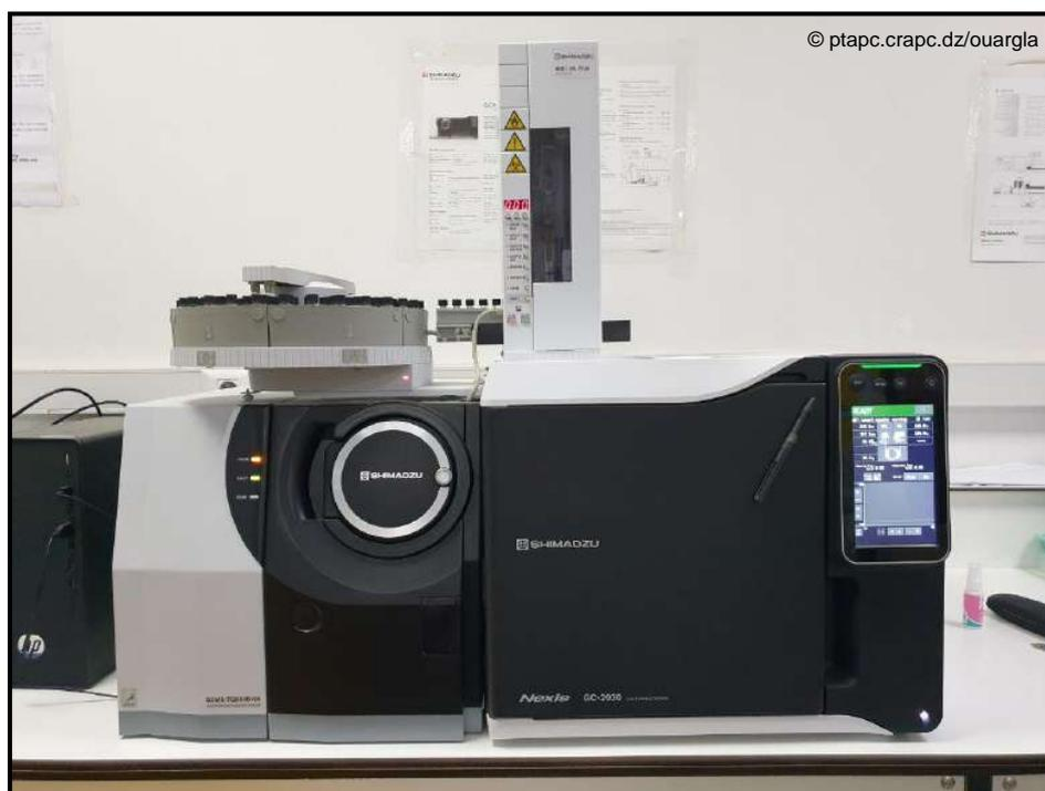
*Figure II.6 : L'appareil de GC/MS.*
