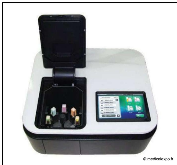
*Figure A. 4 : UV-VIS Spectrophotomètre SP-3000nano.*
