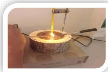
Figure II.6 : appareille de point d'éclair.
