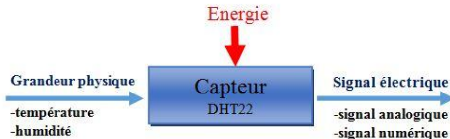
Figure II. 9: Principe des capteurs.
