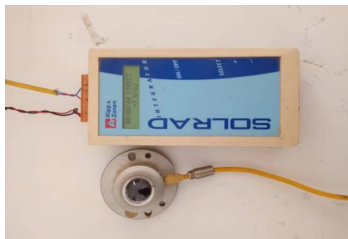
Figure II. 12: Pyranomètre à affichage numérique.
