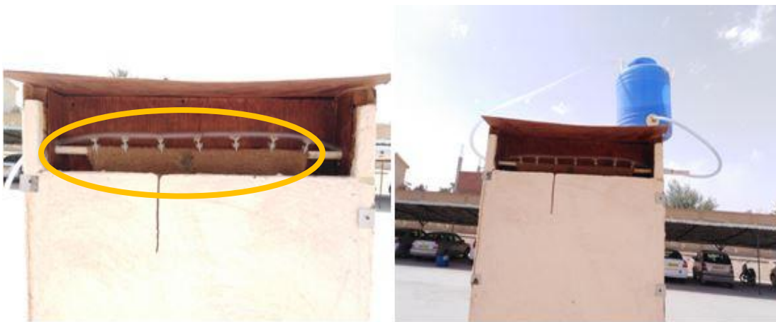
Figure II. 4: Système de refroidissement par évaporation.
