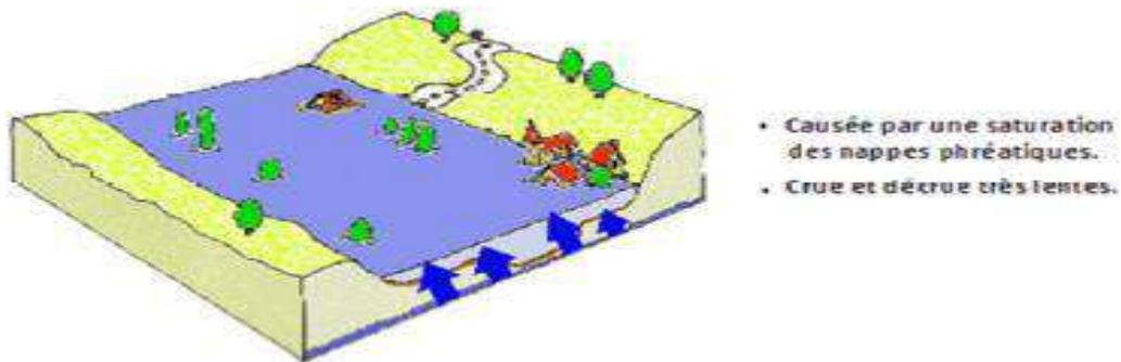
*Figure I-2 : Inondation par remontées des nappes phréatiques*
