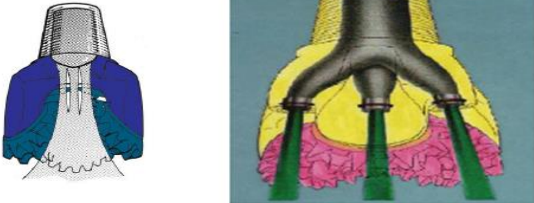
Figure I.7: le passage du fluide à travers les tricônes. À droite : Outil à jet (3 duses), à gauche : Outil conventionnel à circulation Centrale [4]
