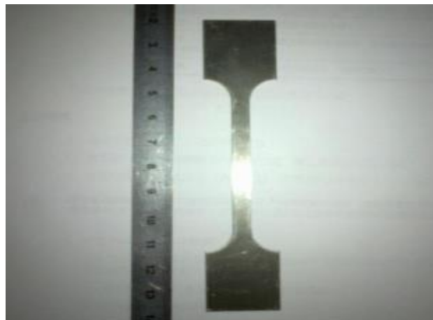
Figure III-2- Eprouvette de dural (AU4G) – épaisseur =1mm, largeur = 6mm, Longueur =50mm [8]
