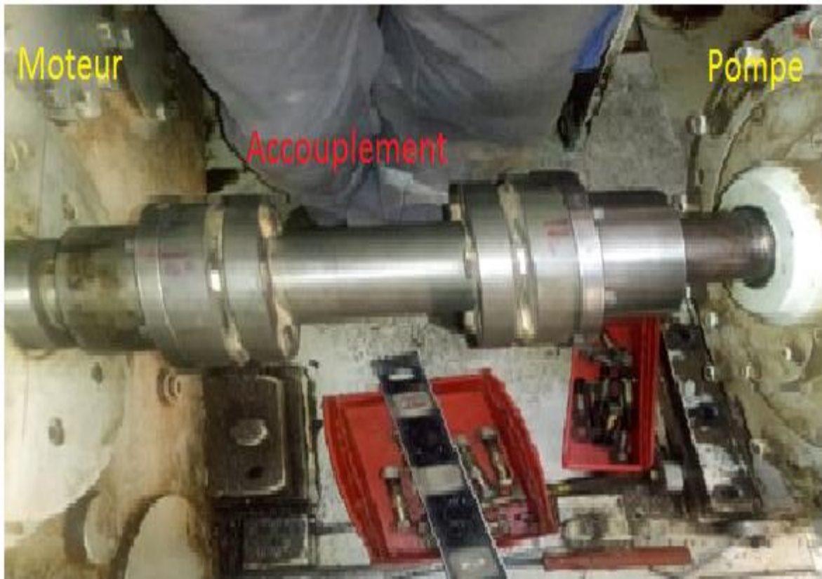
Figure I.6. Accouplement d'une pompe.
