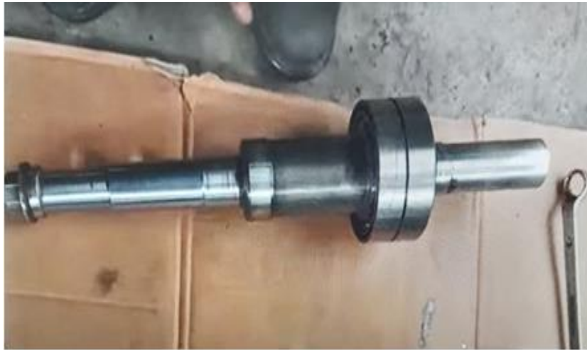
Figure II.2. Arbre de commande de la pompe centrifuge.
