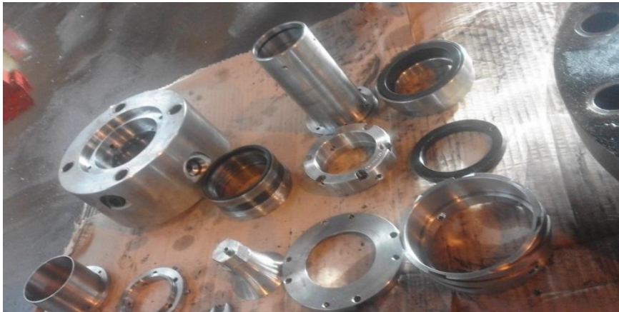
Figure II.7 Composants de la garniture mécanique
