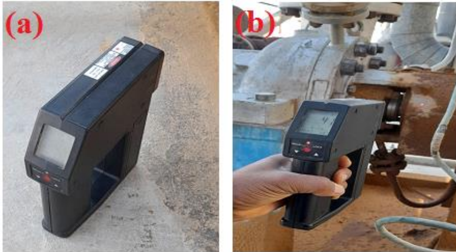
Figure II.11. Test de mesure de la température : a) Thermomètre infrarouge, b) Mesure de la température au niveau de la garniture.
