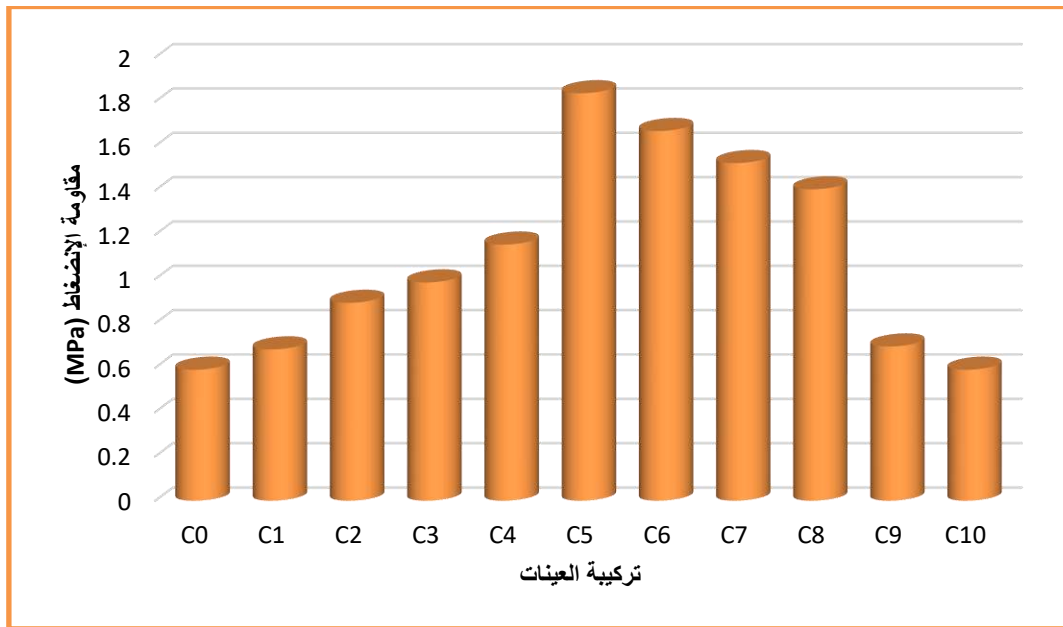
الشكل 3.III مقاومة الطوب للانضغاط بدلالة نسبة الحصى
