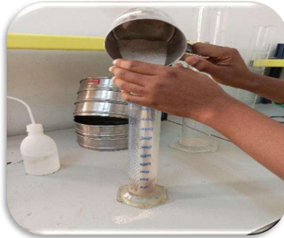
الصورة 4.II تجربة الكتلة الحجمية المطلقة [6]
