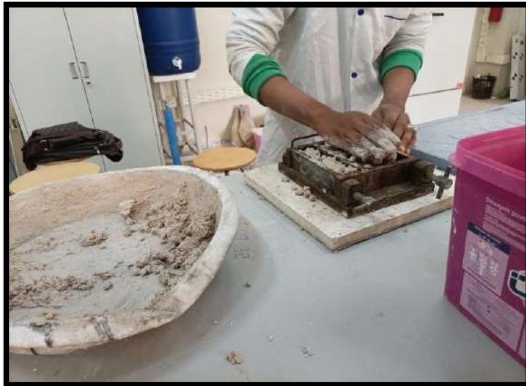
الصورة 3.III خلط وصب العينات
