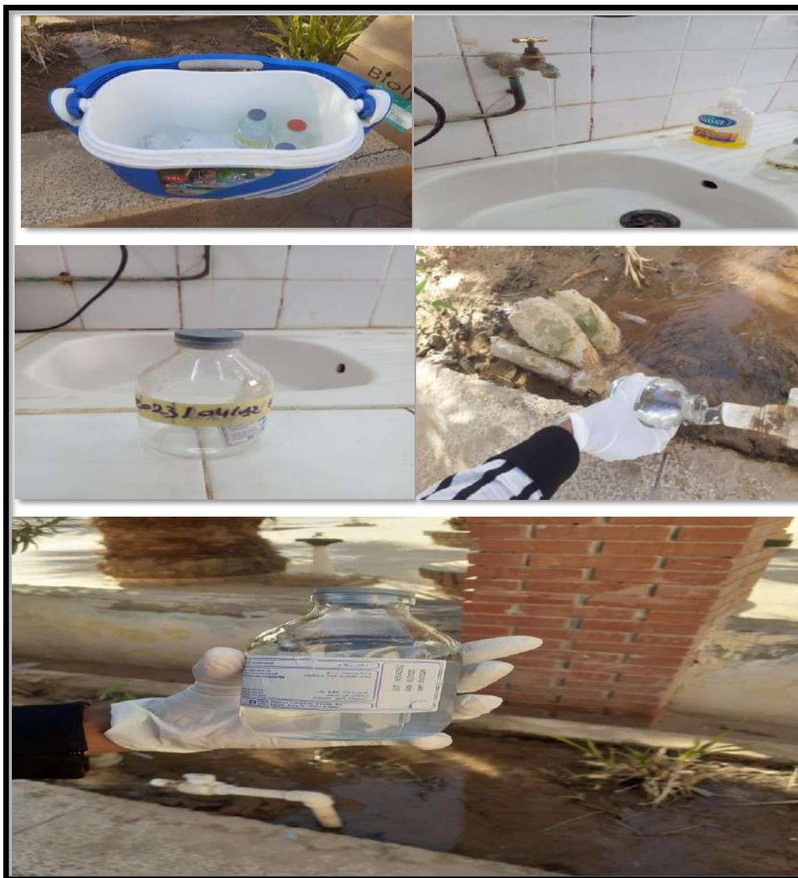
صورة II-2-1: كيفية أخذ العينات من ماء الحنفية
