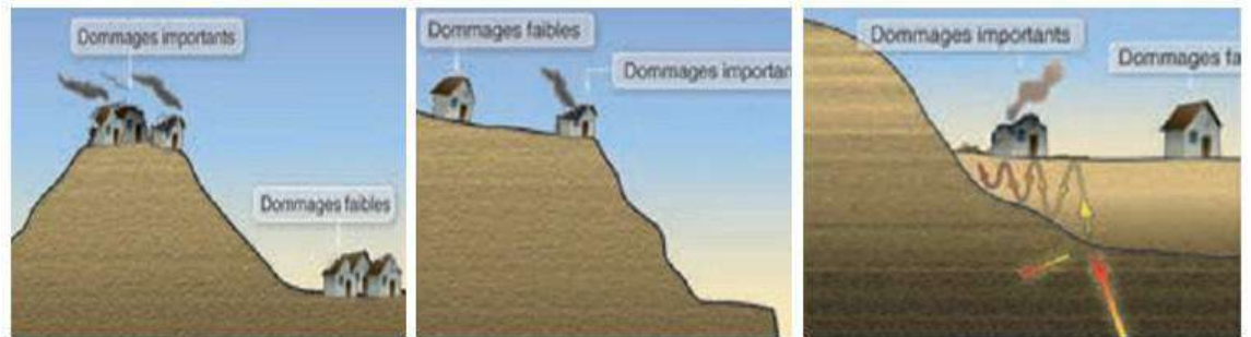
Figure 1.7 – Amplification des ondes sismique par la topographie du site [01].
