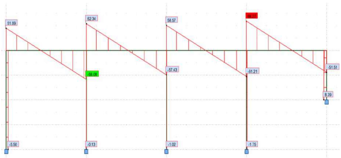
Figure 3.26 : Diagramme de l'effort tranchant pour le 2ème cas du (ST4)
