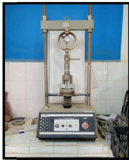
Figure II.4: Dispositif pour l'essai de résistance à la flexion [13].
