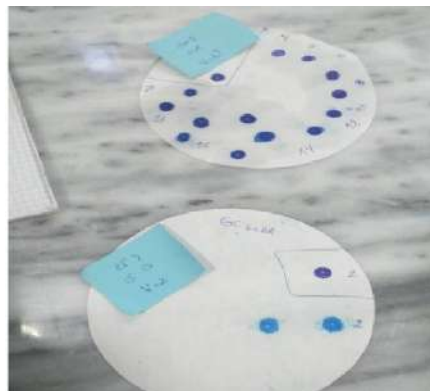
Photo II. 8 : Essai de bleu de méthylène.
