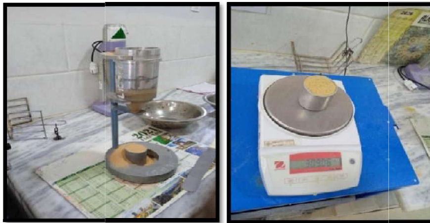
Photo II.5: Essai de la masse volumique apparente.
