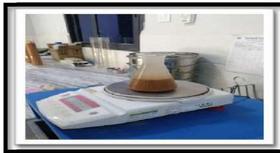
Photo II.6: Essai de la masse volumique absolue.
