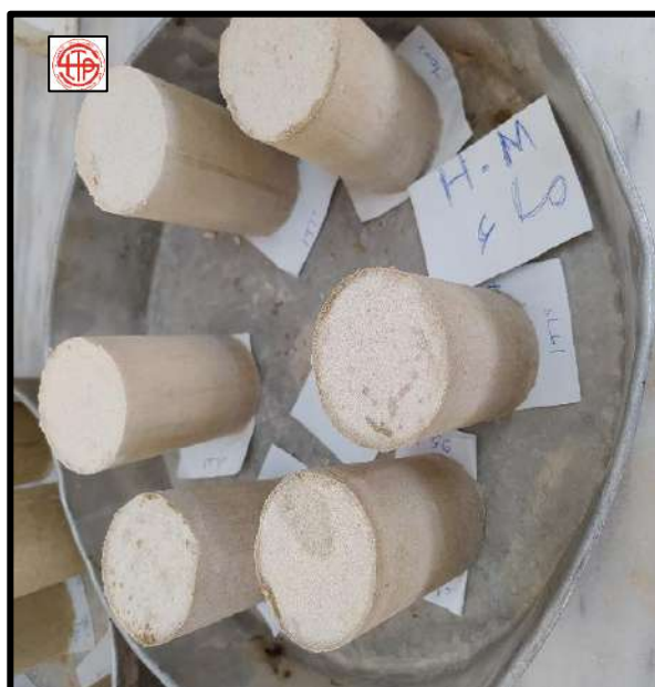
الشكل 3-15 : عينات التيف+الماء بعد رصها وتجفيفها.
