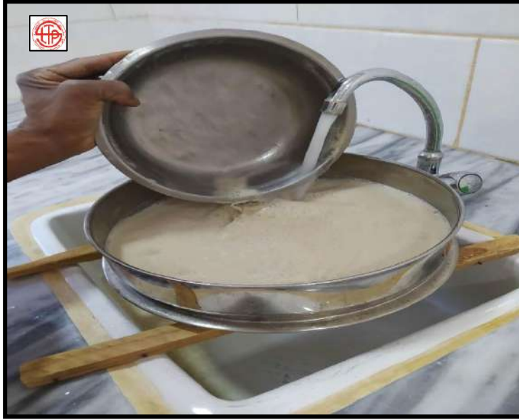
الشكل 3-17 : أثناء غسل عينة التربة على منخل رقم 200 (0.08 مم) لتجفيفها في الفرن لمدة 24 ساعة.
