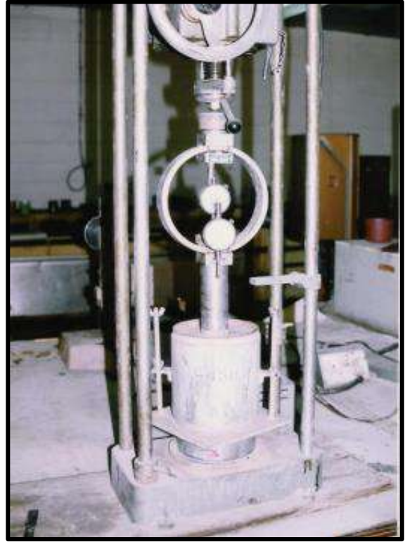
الشكل 3-11 : قالب نسبة تحمل كاليفورنيا CBR في داخل هيكل التحميل. [20].
