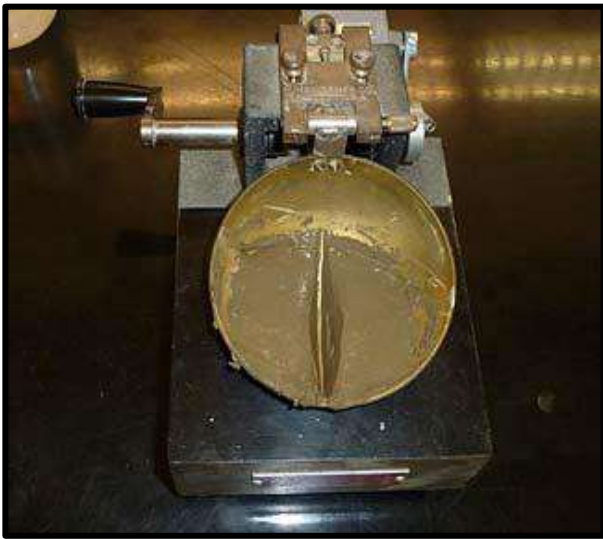
الشكل 3-19 : احداث تلم بواسطة آلة الشق.
