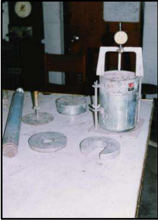
الشكل 3-12 : أجزاء معدات الغمر (CBR imbibé). [20].
