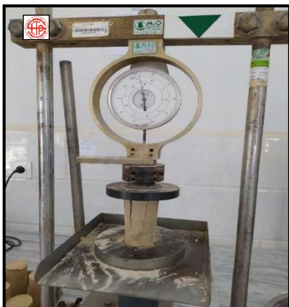
الشكل 3-16 : انهيار العينة داخل جهاز الضغط الميكانيكي.
