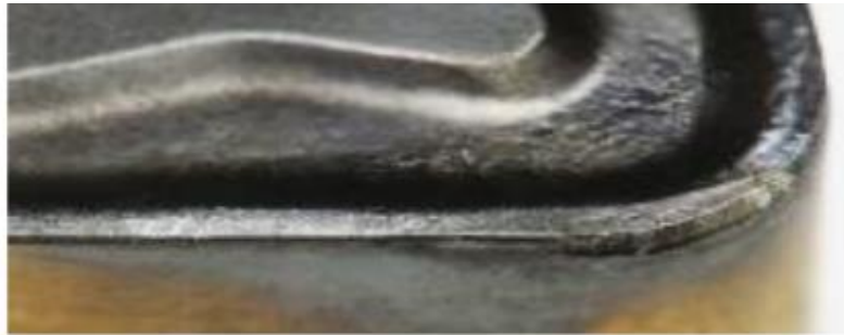
Figure I. 12: Usure en dépouille [8]
