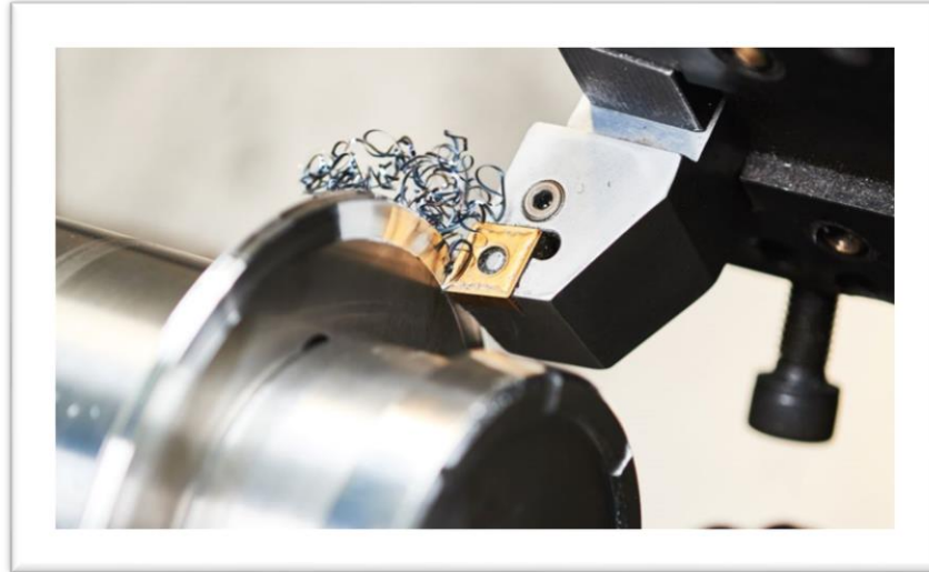
Figure I.2 : Enlèvement de matière par tournage [21].
