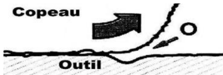
Figure I. 17 : Processus d'usure par oxydation.[12]
