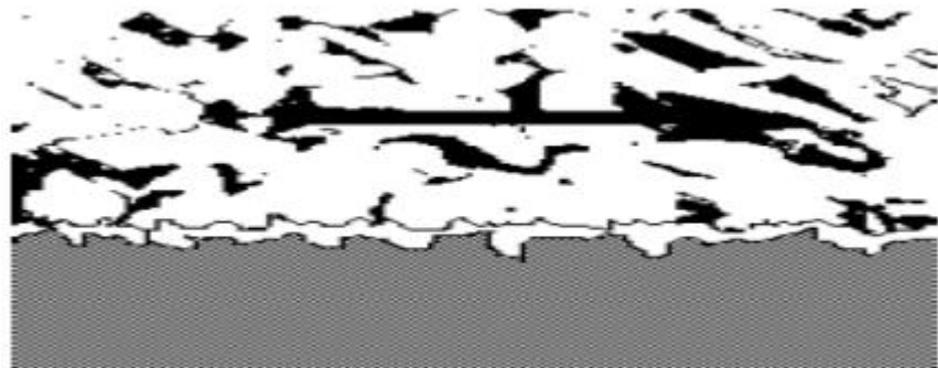
Figure I. 14: Processus d'usure par abrasion [5]
