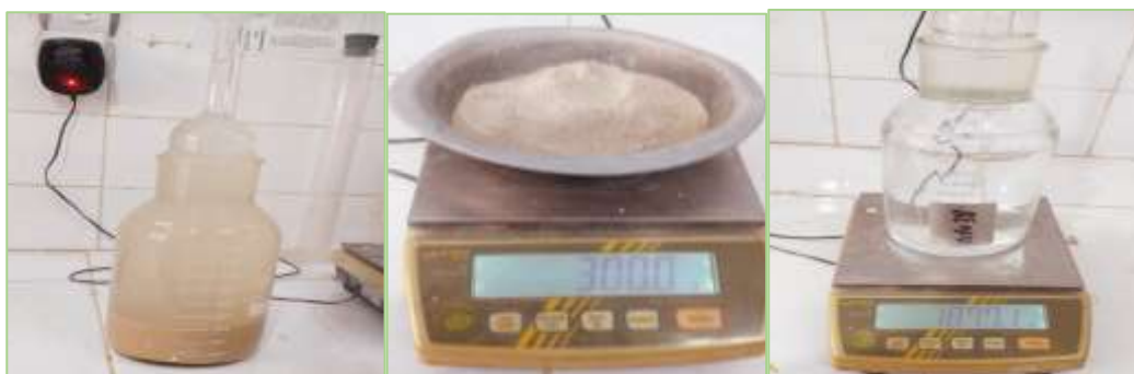
Figure II – 9 : Mode d’opération d’essai masse volumique absolue de poudre sable de dune
