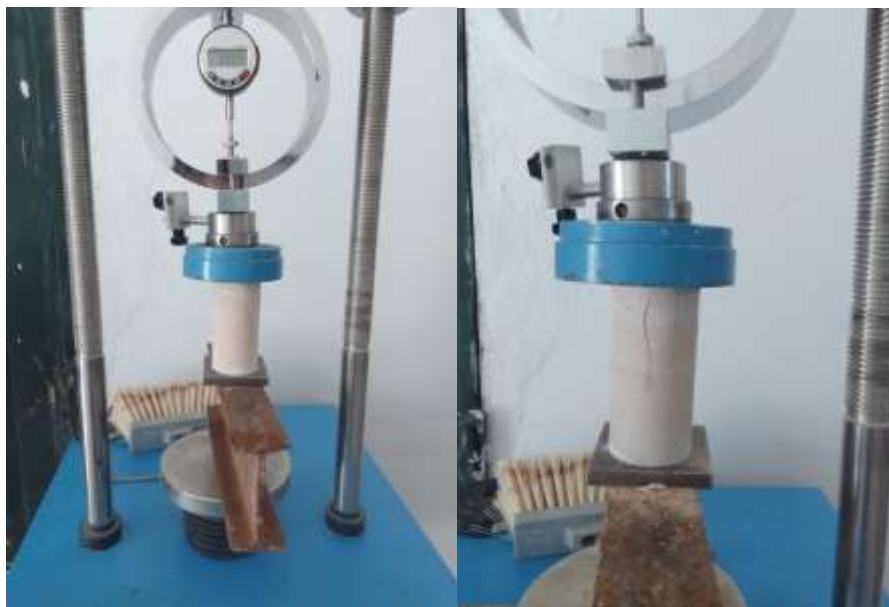
Figure III - 1 : Une éprouvette de compression pendant l'écrasement
