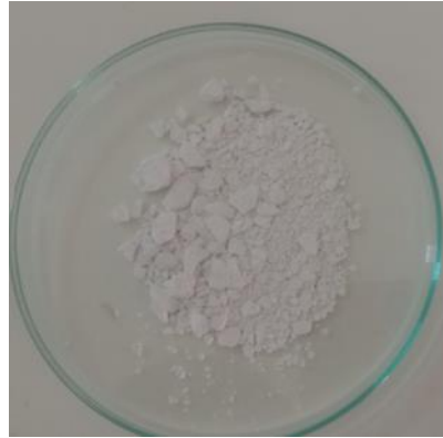
شكل 3.III صورة لأكسيد الكالسيوم المدعم بالسيليكات
