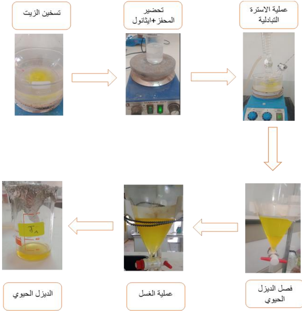
شكل 4.III مراحل انتاج وقود الديزل الحيوي
