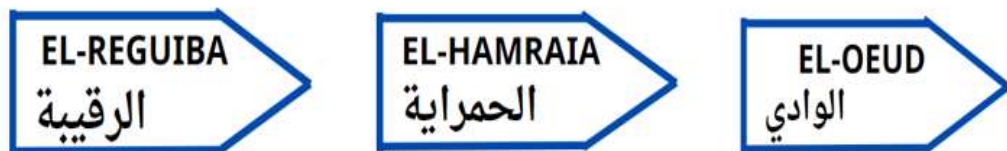
Figure VIII.3 Exemple de signalisation à simple indication
