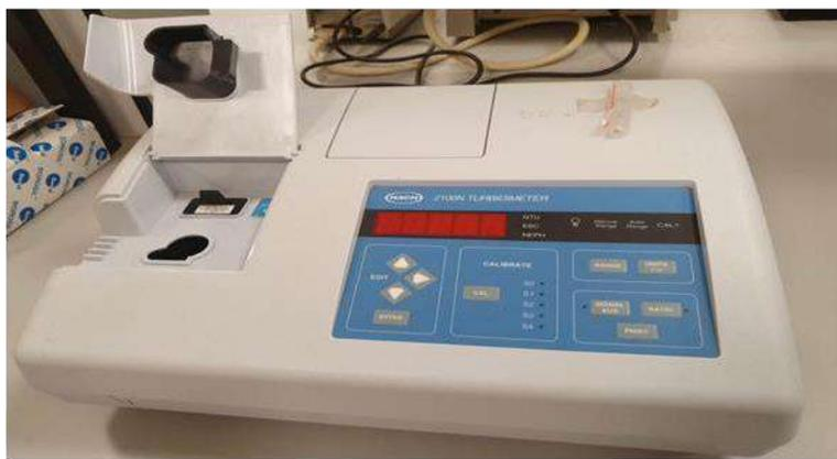
**Figure III.3 Turbidité mètre**
