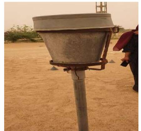
**Figure II.5 pluviomètre**
