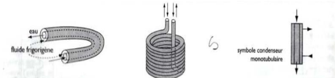
FigureII. 7: Condenseur a tubes concentriques.
