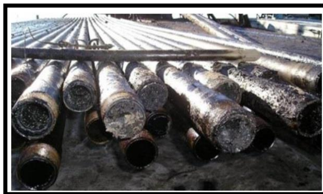
Figure I.5: Dépôt d'asphaltène dans les tubings de production
