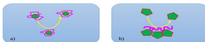
Figure II.1: (a) Dispersion des nucléus formés et (b) Stabilisation des dépôts en croissance.
