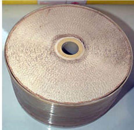
Figure III.15: Les membranes de l'Osmose Inverse.
