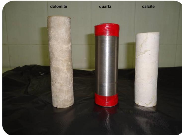
**Figure.IV.2 : Carottes utilisées (Calcite, Dolomite, Quartz)**
