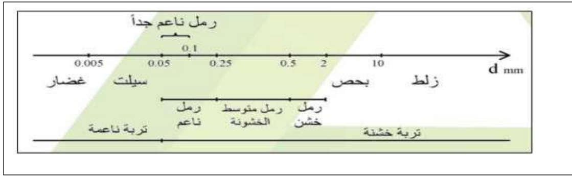
الشكل 4.I: تقسيم حبيبات تربة صلبة حسب نظام SNIP (النظام السوفيتي الخاص
