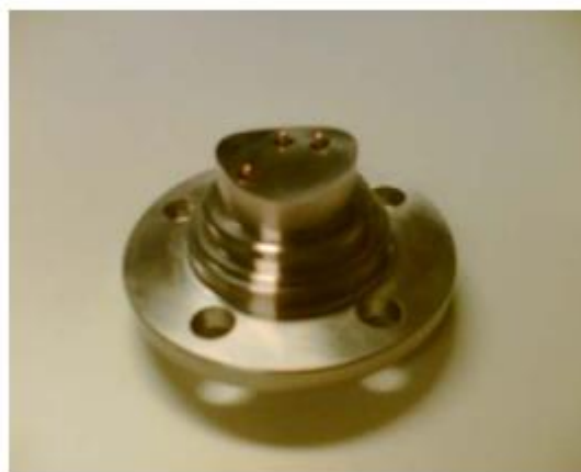
Figure 21: Sonde de salinité montrant les trois antennes .
