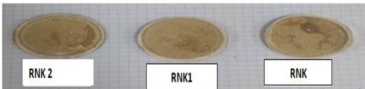
Figure III .9 : résultat test de solubilité de l'échantillon 2(RNK .RNK1.RNK2) (12% minéral, 28% Asphaltène). [47].
