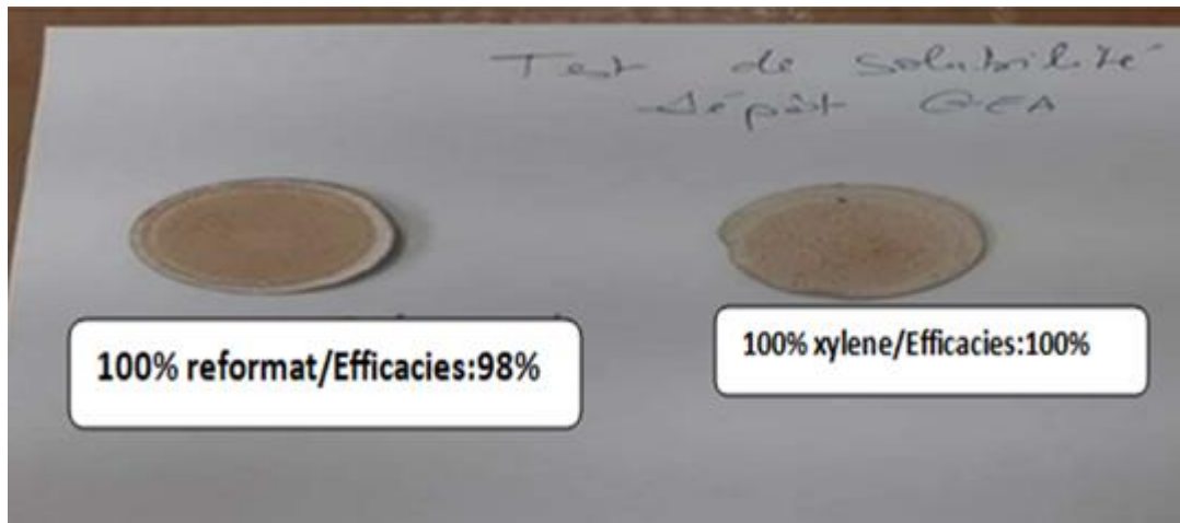
Figure III .7 : résultat test de solubilité de l'échantillon 1 (100%reformat et 100% xylène). [47].
