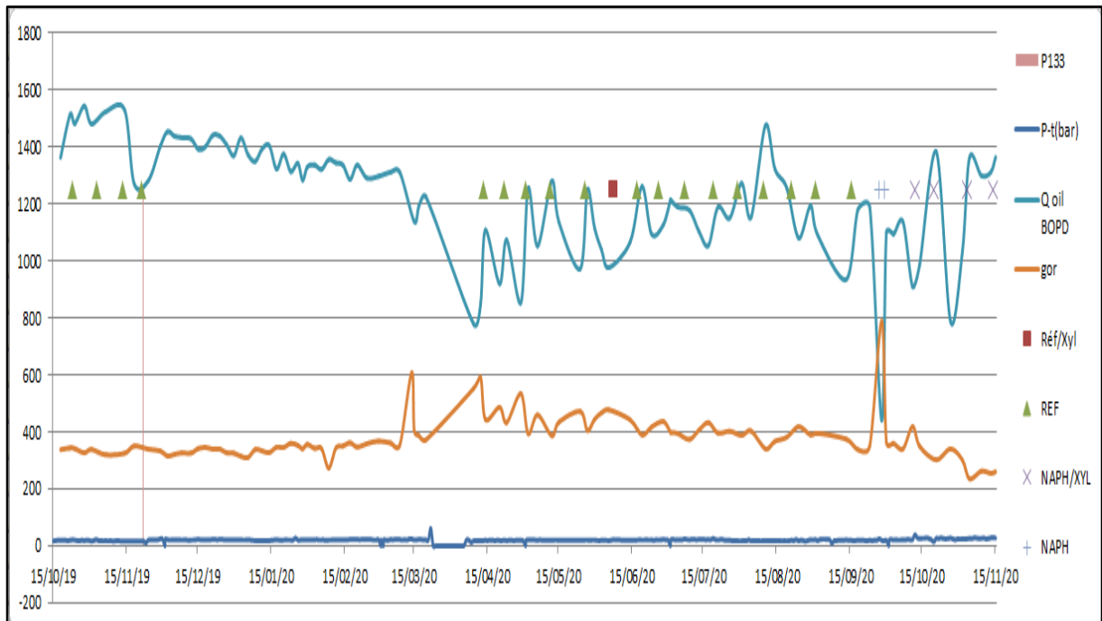
Figure III. 16 : courbe représente l'évaluation de GOR ; pression de la tête de puits pendant période en fonction des opérations des traitements réalisés sur puits AR85. [49].
