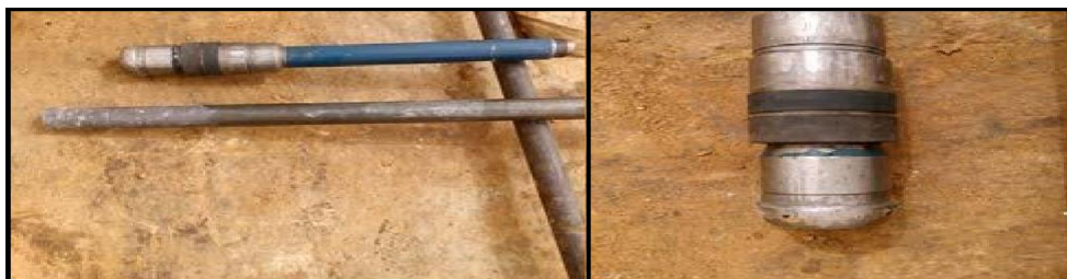
(Figure II.21) : Piston d'ancrage & Mécanisme d'étanchéité de 'Tree-saver'
