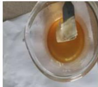
Figure III.6 : Mudfilter Cake trempé dans le traitement MSR100 à 95°C [6]
