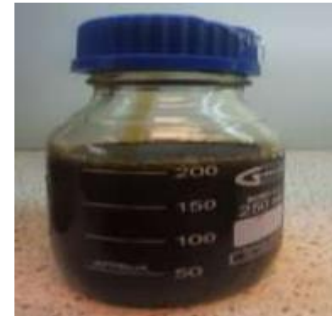
Figure III.3 : Test de compatibilité entre l'échantillon de pétrole brut NAHSE-1 et mélange diesel à 85°[6]
