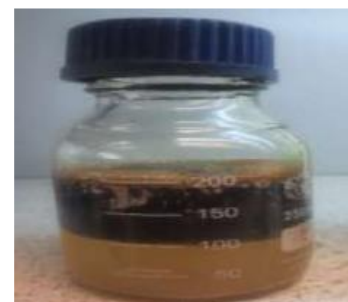
Figure III.1 : Test de compatibilité entre l'échantillon de pétrole brut NAHSE-1 et Live MSR100 à 85°[6]
