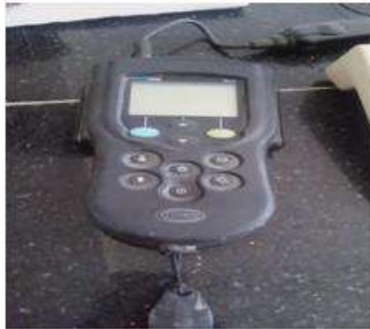
رسم توضيحي 10: جهاز قياس الأوكسجين المنحل.
