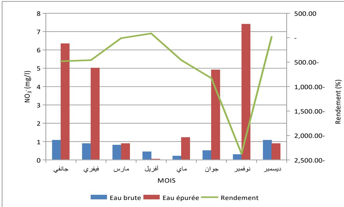
رسم توضيحي 29: تطور  $\text{NO}_3^-$  للمياه الخام والمياه المعالجة (محطة أنفوسة).
