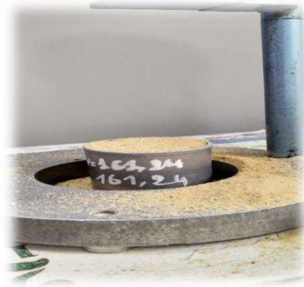
**Photo(II.1) :** Mesure de La masse volumique
