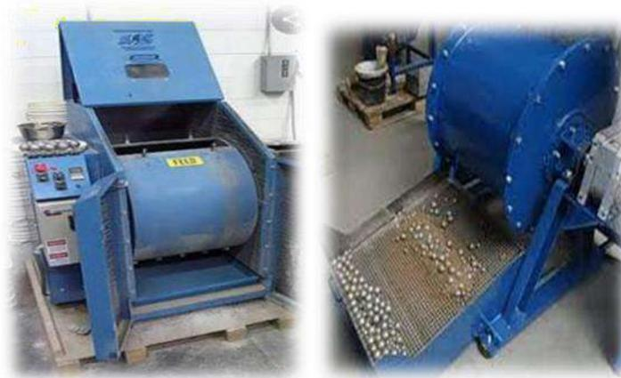
**Photo(II.5) :** Appareil de l'essai Los Angeles
