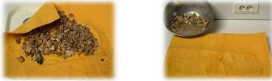
**Photo(II.4) :** Séchage de l'échantillon à l'aide d'un chiffon.
