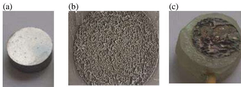
Figure II.13 Étude visuelle de la morphologie de surface du revêtement composite Ni-P-5 g/l Y 2 O 3 (a), Ni-P-7,5 g/l Y 2 O 3 (b), Ni-P-10 g/l Y 2 O 3 (c), avec 5A/dm 2 , 365 tr/min.
