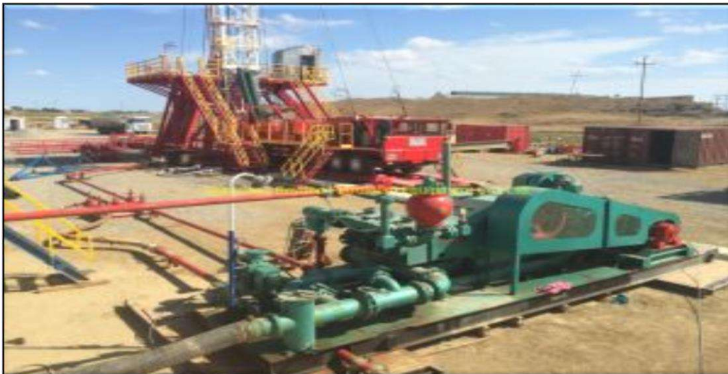
Photo 8: La pompe à boue. [9]
