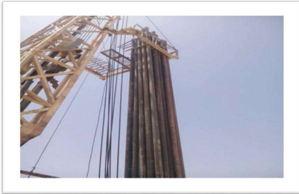
Photo 10: Les tiges de forage. [10]
