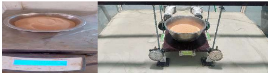
Figure (IV.1) : L'ajout du poids aux fondations.
