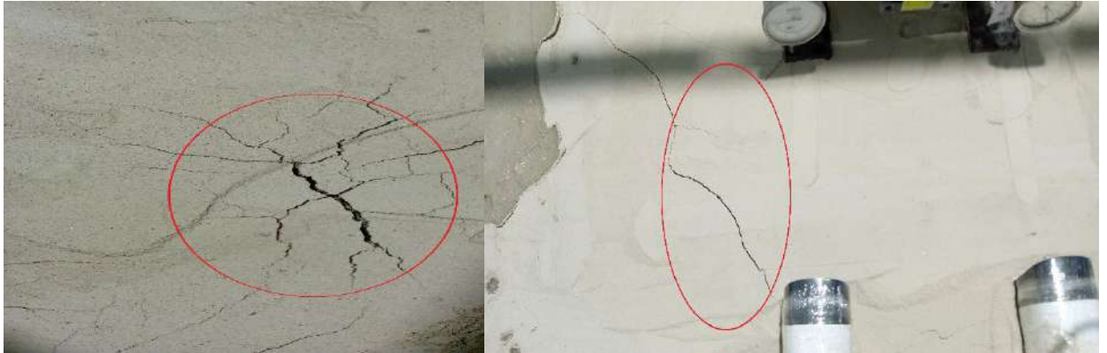
Figure (IV.3) : Apparition de fissures à la surface de la couche argileuse.
