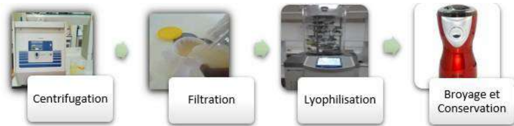
Figure III.4 Processus de la purification et conservation du collagène.
