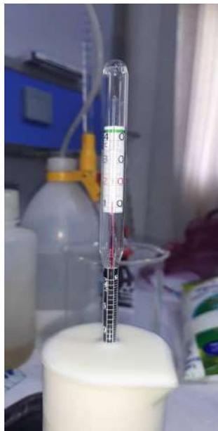
**Figure 16** : Détermination de la densité
