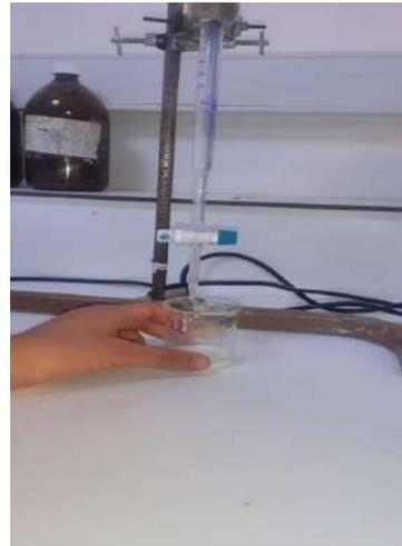
**Figure 15** : Détermination de l'acidité titrable
