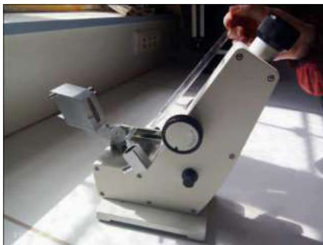
Figure 10 : Réfractomètre utilisé pour mesurer le Degré Brix des échantillons. photographie originale, (2023)
