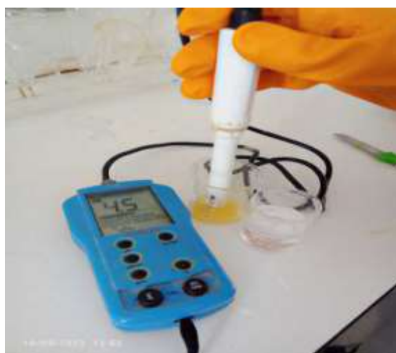
Figure 08 : Mesure du pH des échantillons à l'aide du pH-mètre. (Photographie originale, (2023))
