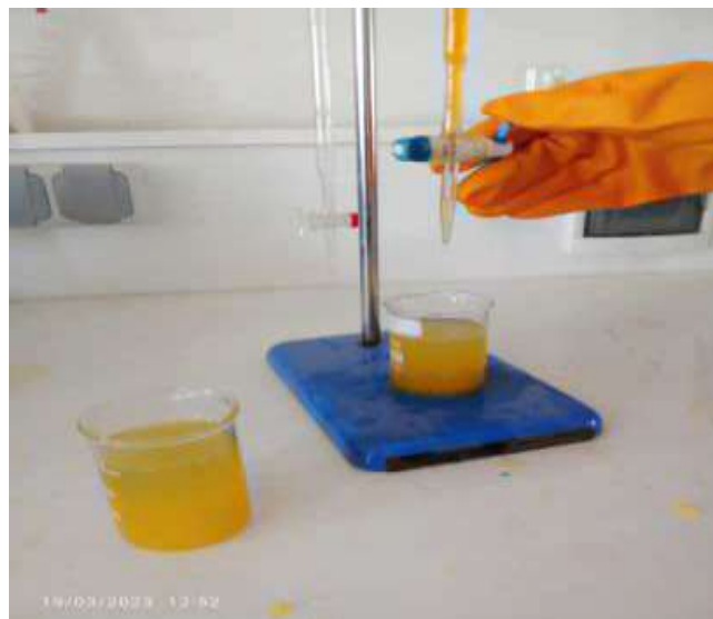
Figure 09 : Mesure de teneur en vitamine C par une Titrage iodométrique
